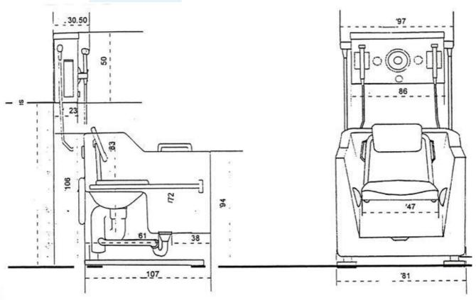
Distanza da parete allo scarico a pavimento 30 min. - 40 max cm Dimensione Scarico DIN 110.
