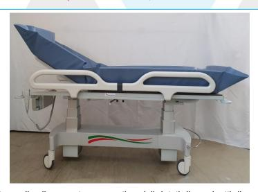
Robusta struttura del sistema di sollevamento con punti assiali dotati di cuscinetti di supporto e rinforzi in Teflon. La base metallica è rivestita con polveri elettrostatiche. Struttura stabile su 4 ruote da 200 mm e sistema frenante centralizzato. Semplicità di utilizzo, grazie alla possibilità di blocco unidirezionale delle ruote.
